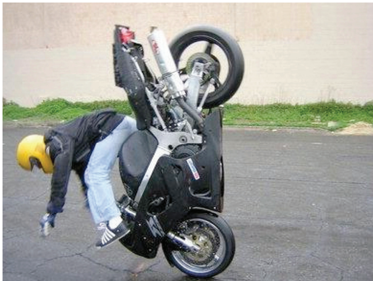
Figura 2.24 – Assetto di un motoveicolo a seguito di eccesso di frenata (moto per cappello)
