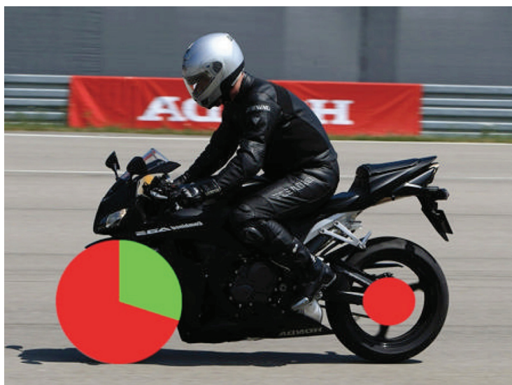
Figura 2.22 – Assetto di un motoveicolo in frenata decisa
